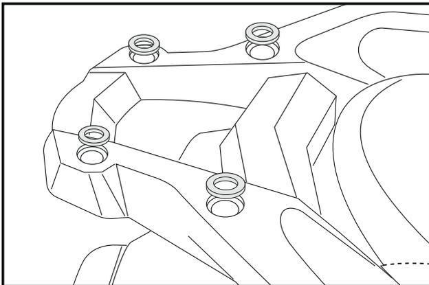
Die U-Scheiben Ø8,4x3mm in die Bohrungen des originalen Gepäckträgers einstecken.
