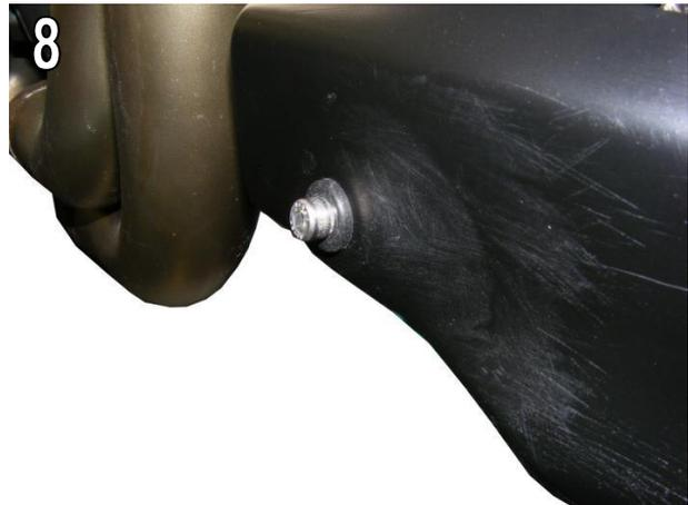
**WICHTIG: Überprüfen Sie regelmäßig die Ausrichtung des Bugspoilers und die Spannung der Befestigungsschrauben. / IMPORTANT: Always check alignment of the belly pan and mounting bolt tension periodically.**
