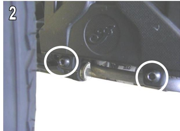
4. Befestigen Sie das Mittelteil (3) mittels der Originalschrauben. Abb.3 / Fit central part (3) to bike using original screws as in Fig.3
