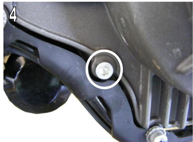
6. Entfernen Sie die Motorschraube auf der rechten Seite. Abb.5 / Remove R/H engine screw as indicated. Fig.5
