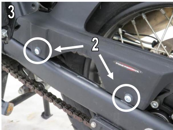
6. Befestigen Sie die Bremsleitungshalter auf der Hinterradabdeckung mittels der M6x20 Linsenkopfschrauben (5). Abb.4/ Fit Brake line brackets on top of the rear hugger using the M6x20 Screws (5). Fig.4
