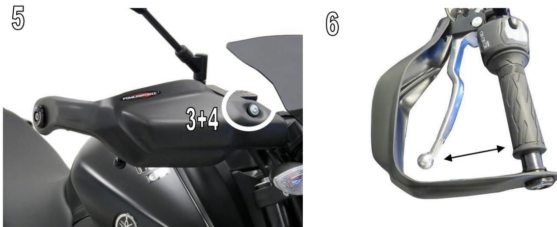
**WICHTIG: Überprüfen Sie regelmäßig die Ausrichtung der Handschützer und die Spannung der Befestigungsschrauben. / IMPORTANT: Always check alignment of hand guards and mounting bolt tension periodically.**
